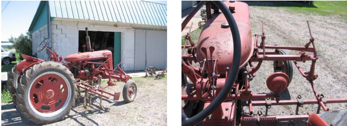
Figure 3 – Vue de côté et vue du siège du conducteur d'un tracteur Farmall Super C démontrant la facilité de vision que procure ce type de tracteur lors du désherbage
